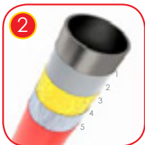
2 Solid sandblåst og galvanisert konstruksjon laget av sort stål S235JR, Pulverbelegg med polyesteremaling QUALICOAT attestert. 1 -stål, 2 - sandblåsing, 3 - jern fosfativering, 4 - sinkbase,
