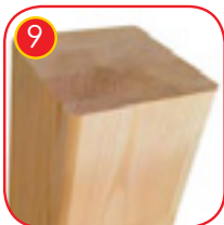
9 Mykt bartre 140 x 140 mm, kjerneløs, knuteløs, limt i lag med polyuretan lim, helt motstandsdyktig mot vann. Trestolper bearbeidet i tre-fase impregneringsprosess.
