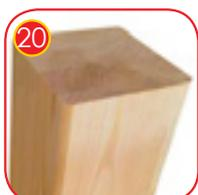
20 Mykt bartre 140 x 140 mm, kjerneløs, knuteløs, limt i lag med polyuretan lim, helt motstandsdyktig mot vann. Trestolper bearbeidet i tre-fase impregneringsprosess.
