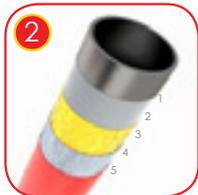
2 Solid sandblåst og galvanisert konstruksjon laget av sort stål S235JR, Pulverbelegg med polyesteremaling QUALICOAT attestert. 5 - polyester pulveremaling
