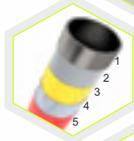
Konstruksjon av sandblåst svart stål S235JR. Galvanisert, pulverlakkert med sertifisert polyesterfarge.
