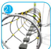
21 Passasjemodul laget av polypropylen tau Ø 16 mm m stålkjerne, AISI204 rustfritt stål og HDPE plate. Tauender klemte i ermer laget av holdbare aluminiumslegeringer. Passasjemodulen er laget av en 6 mm kjede i rustfritt
